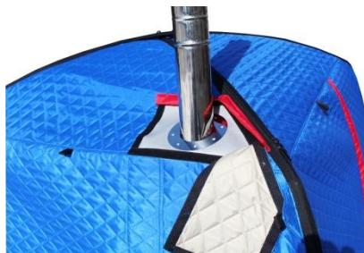
Разделка дымохода изготовлена из нержавеющей стали и специальной стеклоткани с силиконовым двухсторонним покрытием, рассчитана на установку печей с диаметром дымохода 90 мм, для установки печей с меньшим диаметром дымохода используйте переходник закрепляемый на клапан дымохода. Для доступа воздуха к печи вшито вентиляционное окно закрытое клапаном и москитной сеткой внизу палатки.
