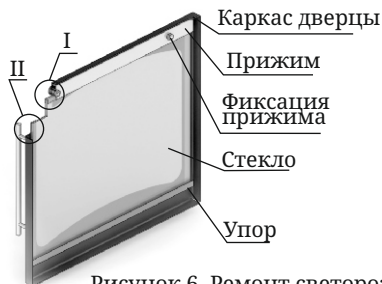
Рисунок 6. Ремонт светорозрачного экрана дверцы модификации «Люмина»
