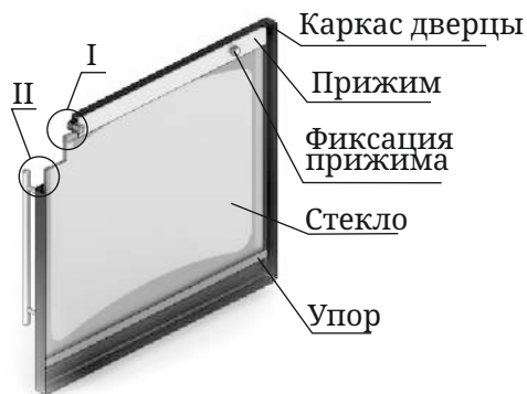
Рисунок 15. Ремонт светопрозрачного экрана дверцы модификации «Витра»
